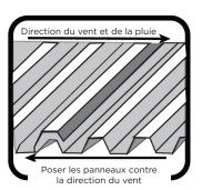
Note: Ne mettez pas de scellant entre les panneaux qui se chevauchent. Le silicone n'est pas requis entre les chevauchements et pourrait endommager le panneau.
