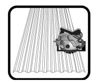
Note: Portez toujours des lunettes de protection et des gants pour couper les panneaux en polycarbonate ondulés.
