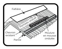
Vérifiez toujours les panneaux et les moulures pour s'assurer qu'ils soient bien ajustés. Les moulures peuvent venir avec un adhésif, doivent correspondre à l'ondulé du panneau et doivent être compatibles avec le polycarbonate.
